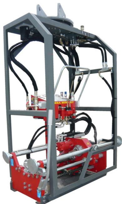
TERRA MINI-JET MJ 1600 в раме экскаватора. Работает от гидравлики экскаватора.
