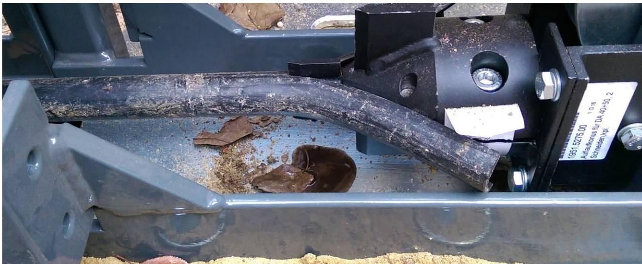
Рис 5: При резке старой трубы имеется тенденция трубы сминаться и выдавливаться из под земли, поэтому имеется на стенке боковое лезвие. Оно задаёт направление выдавливания. При резке старой трубы получается вид гармошки, приходится отрезать и удалять.
