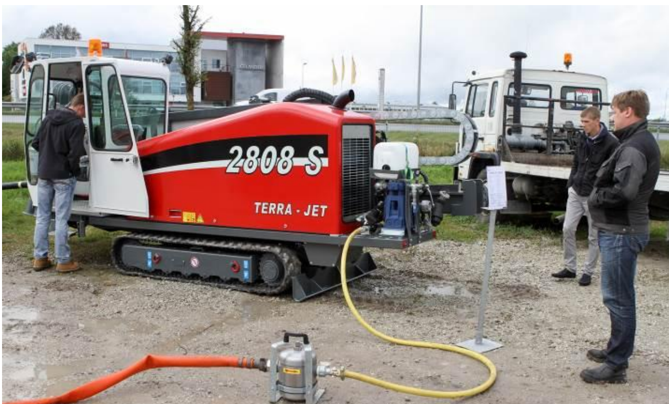
Фото 4: TERRA-JET TJ 2808 S при подключении сжатого воздуха работает как молот.
