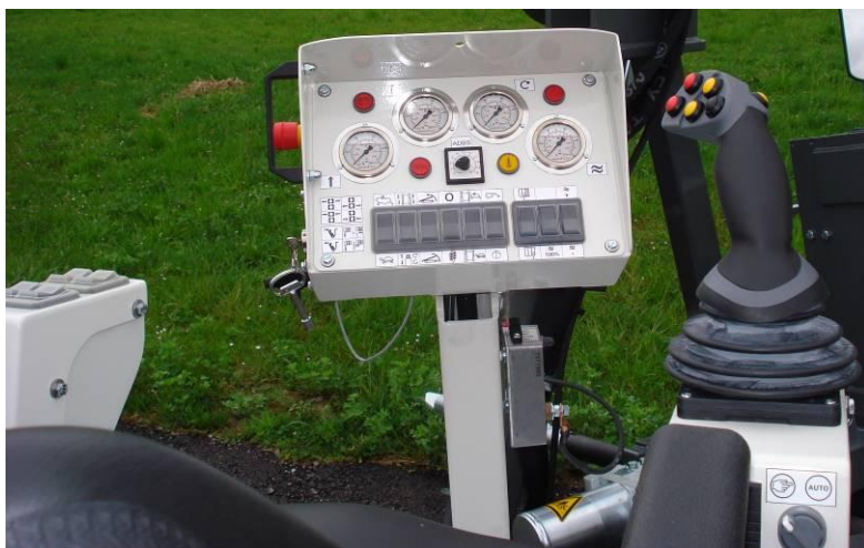
Фото 6+7: TERRA-JET остаётся верной своей удобной концепции управления. Управление только с помощью одного джойстика, легко и безопасно. В автоматическом или ручном режиме, TERRA-JET всегда работает эффективно и мощно.
