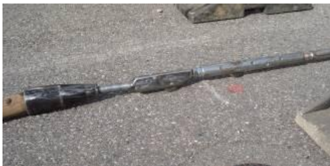
← Комплект состоит из роликового ножа 2", дополнительный хвостовой нож, расширительный конус Ø 100 мм.
