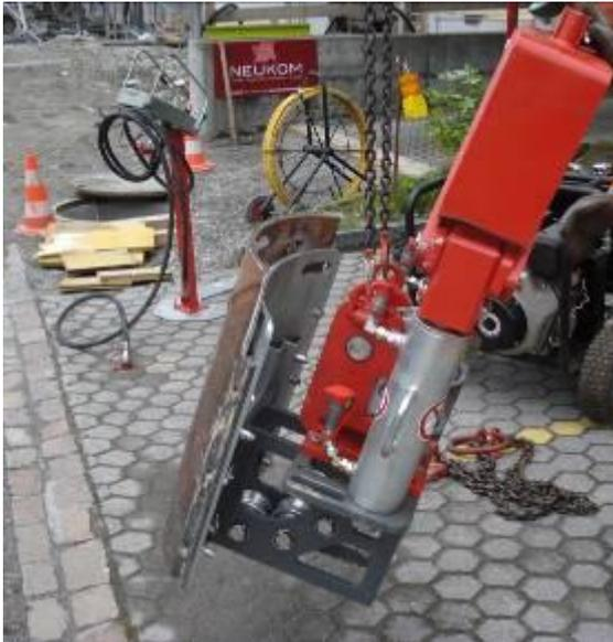
Тросовый разрушитель X 300 C с вогнутой фронтальной платой готов для работы в колодце Ø 800 мм.
