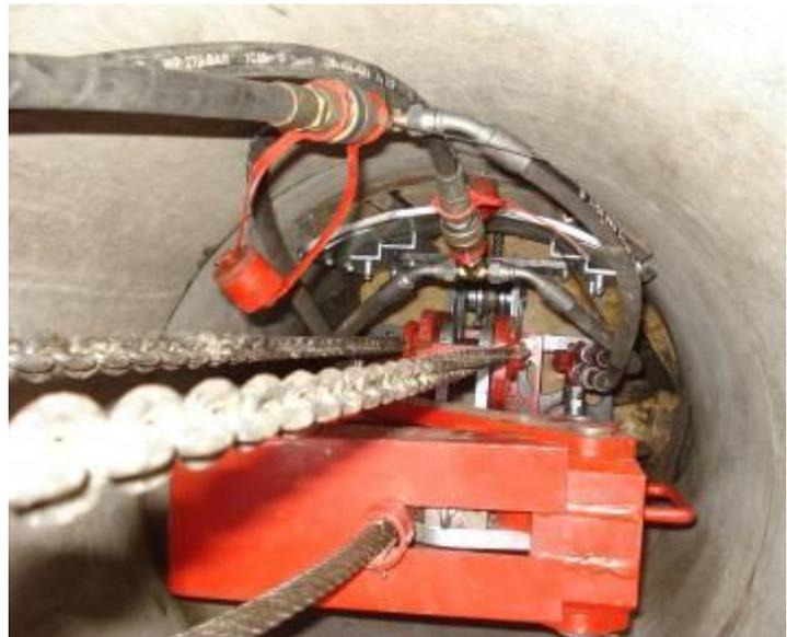
Тросовый разрушитель X 300 C в колодце Ø 800 мм.
