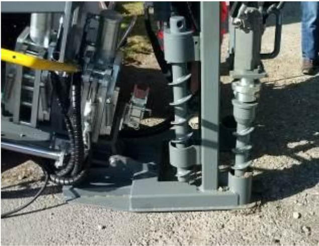
Крепление установки на поверхности происходит гидравлически при помощи анкерной системы, которая способна задавливать анкера даже в асфальт.
