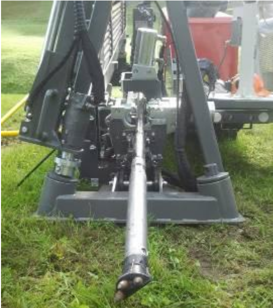
Начало пилотного бурения. Трехпальцевая головка предназначена для бурения в твердых и каменистых грунтах.
