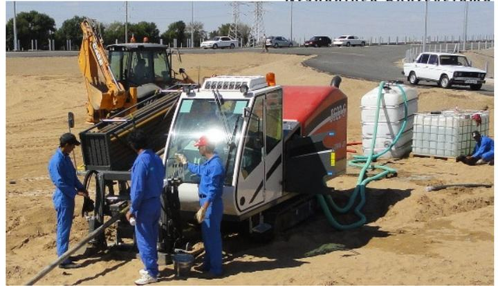
TERRA-JET 8522 S во время бурения. Комфортная кабина оператора охлаждается мощным кондиционером (Мощность 6kW).
